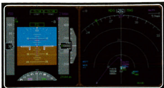
Écran 13. L'ADI et l'EHSI après sélection de leurs modes respectifs. Notez les informations WXR et ARPT sur l'écran de droite.
