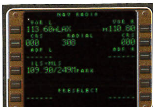
Écran 12. Les aides radio sont sélectionnées.
