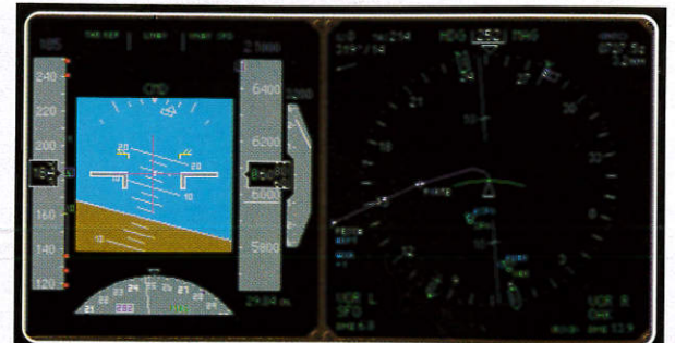
Écran 6. Premier virage vers PORTE, la vitesse est toujours de 185 nœuds et les volets abaissés à 10°.
