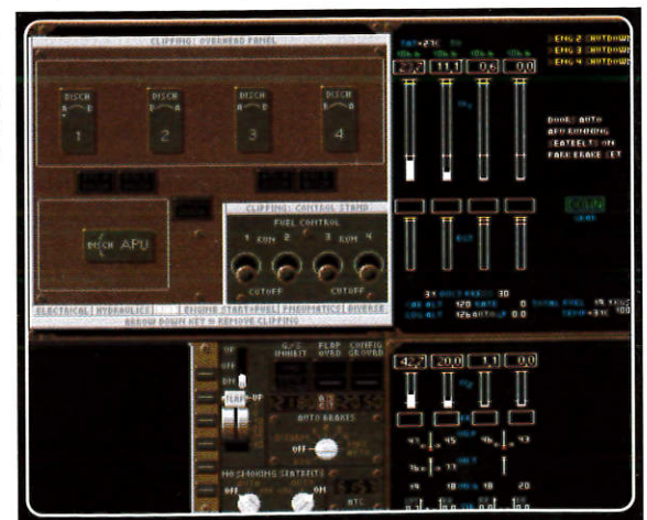
Écran 16. Les CF6 sont coupés. Notez les paramètres en diminution sur l'EICAS.
