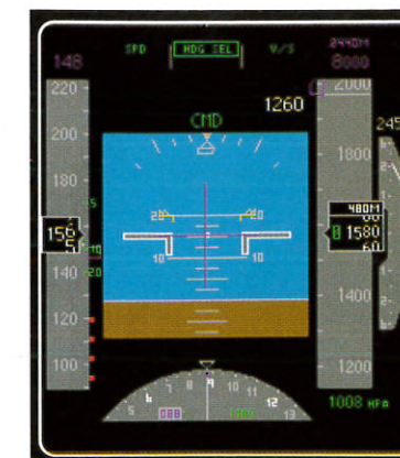
Écran 7. L'autopilot est engagé, ses modes étant confirmés sur le FMA.
