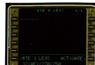
Écran 19. Chaque commande spécifique est écrite ligne par ligne dans le menu RTE LEGS.
