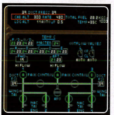
Écran 5. La synoptique de la pressurisation sur l'EICAS. Notez l'altitude cabine et le taux, entourés en rouge.
