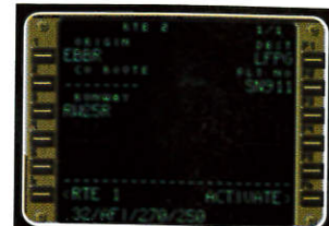
Écran 18. Données fondamentales à introduire dans l'écran RTE pour toute procédure.
